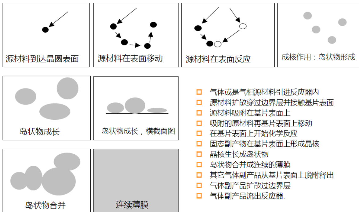
图 3.4-6 化学气相沉积工艺流程图
